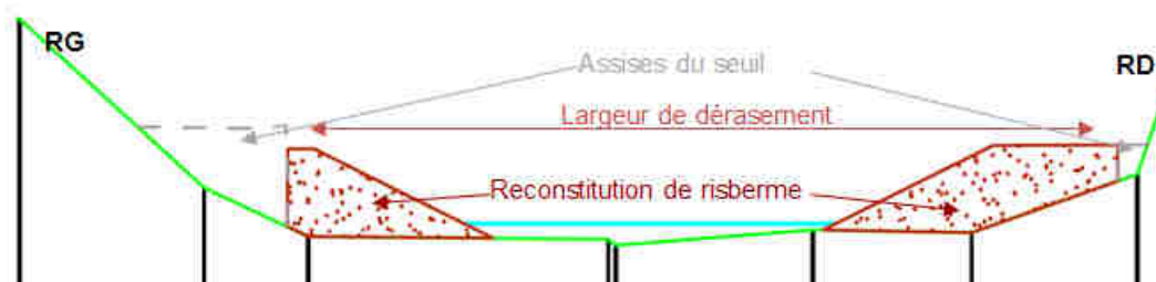
Figure 13 : Seuil de Roque Figuier amont après dérasement
