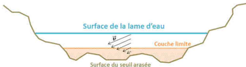
Figure 5 : Illustration de la rugosité de l'échancrure et du gradient de vitesse en résultant
