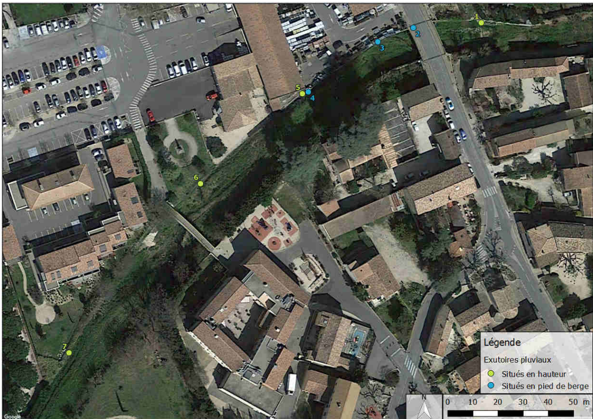
Figure 28 : Localisation et position des exutoires pluviaux
