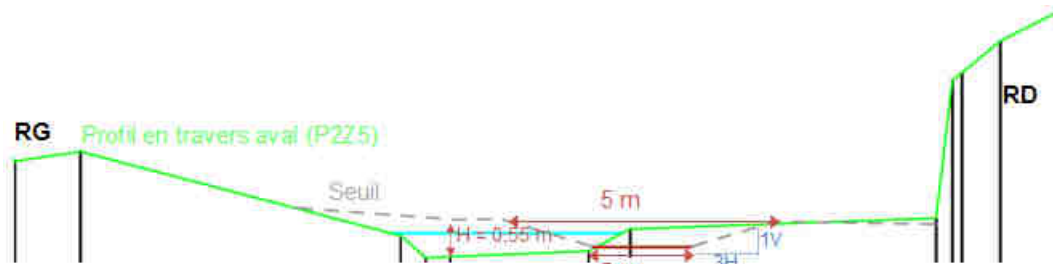
Figure 7 : Seuil de la Gendarmerie après arasement de la partie centrale
