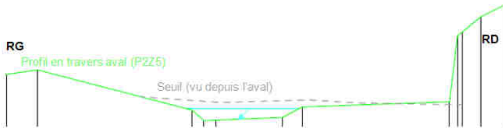
Figure 6 : Seuil de la Gendarmerie avant arasement de la partie centrale
