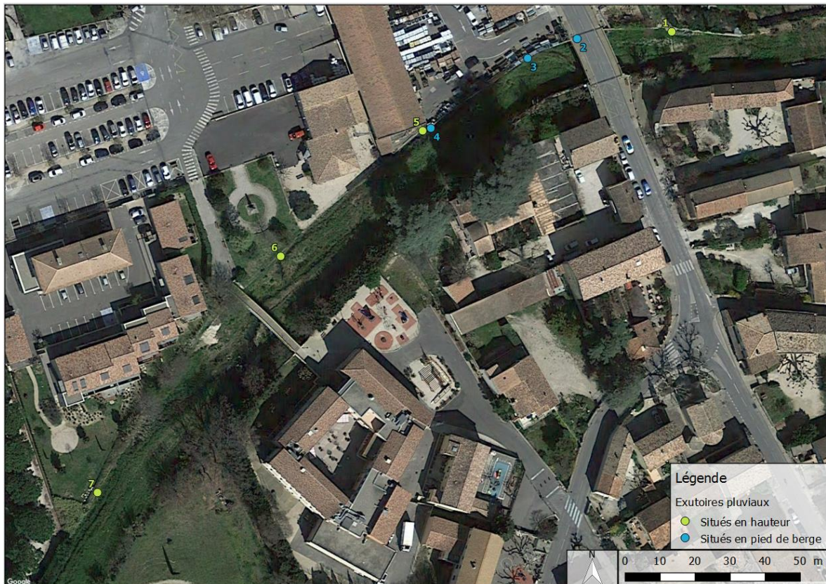
Figure 28 : Localisation et position des exutoires pluviaux
