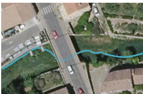
Figure 71 : Tracé actuel du cours d'eau au niveau du pont de la RD21 et localisation des épis déflecteurs
