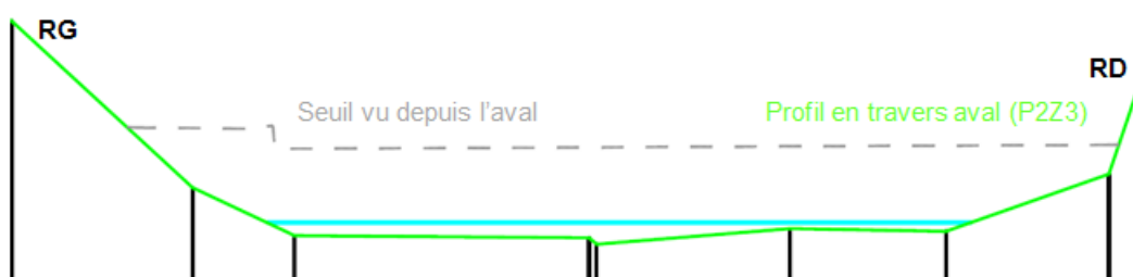
Figure 12 : Seuil de Roque Figuiet amont avant dérasement
