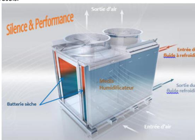
Figure 5 : Principe de fonctionnement d'un condenseur adiabatique
