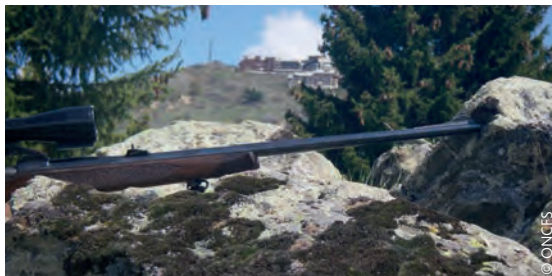
Position dangereuse : obstruction de la bouche du canon par un rocher
