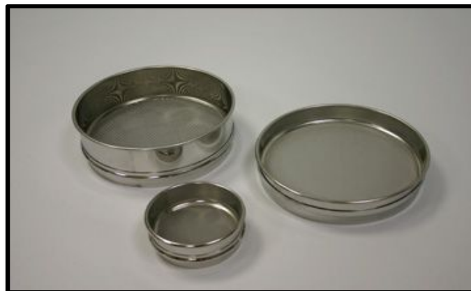
Figure 11 : Tamis inox norme NF ISO 3310-1 et 3310-2 (Source photographique : Saulas)
